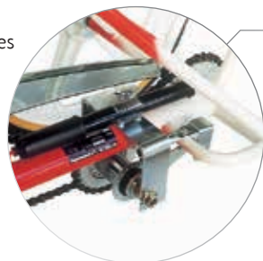
Moyeu 3 vitesses avec frein tambour et roue libre intégrée (T3/T4)
